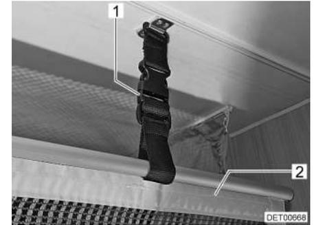
Fig. 40 Soporte red de seguridad
