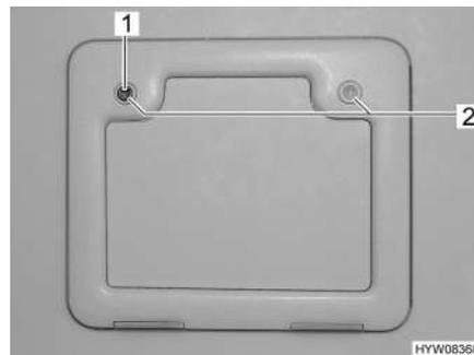
Fig. 93 Trampilla para el depósito de aguas fecales (alternativa)
