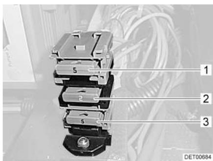
Fig. 61 Fusibles junto al bloque eléctrico
