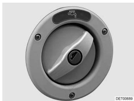
Fig. 79 Tapa de cierre para el tubo de llenado de agua potable
