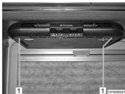
Fig. 96 Desmontar la cubierta inferior
