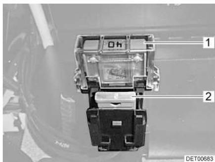
Fig. 60 Fusibles en la batería del habitáculo
