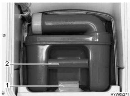
Fig. 94 Depósito de aguas fecales
