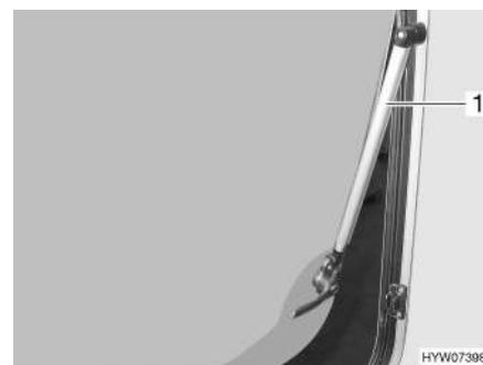
Fig. 11 Ventana abatible con soporte automático
